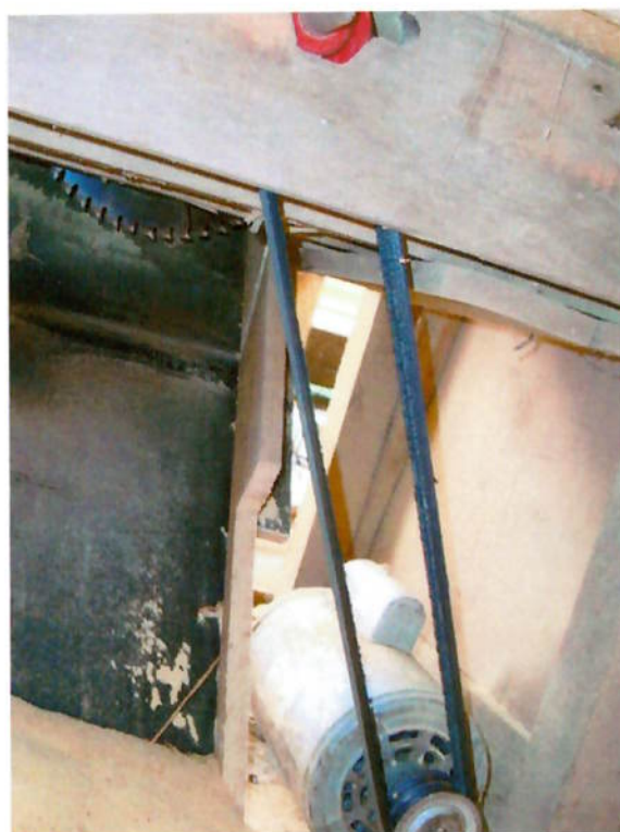
Figura 14 – Sistema de transmissão do motor.
