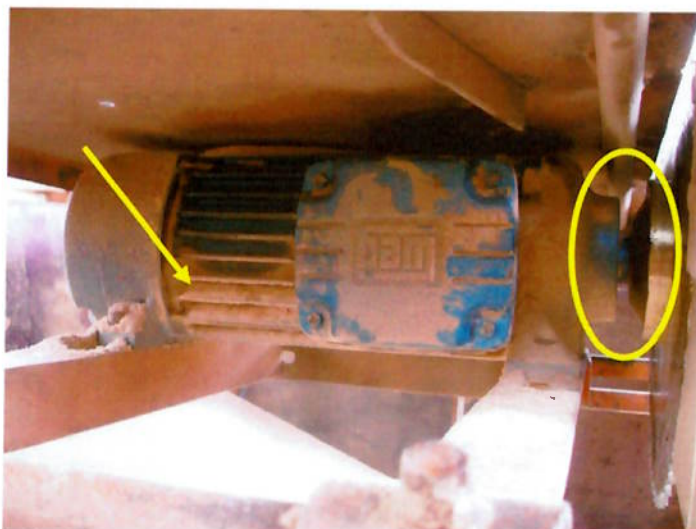
Figura 24 – Ausência de sistema de transmissão.
