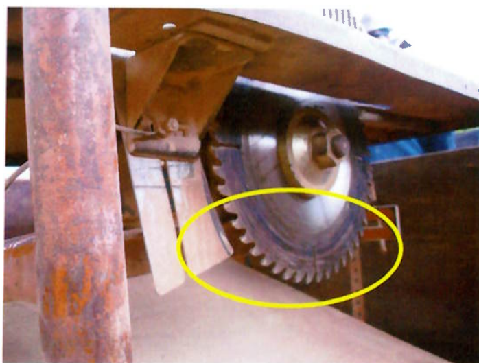
Figura 25 – Ausência de isolamento dos equipamentos com o operador.
