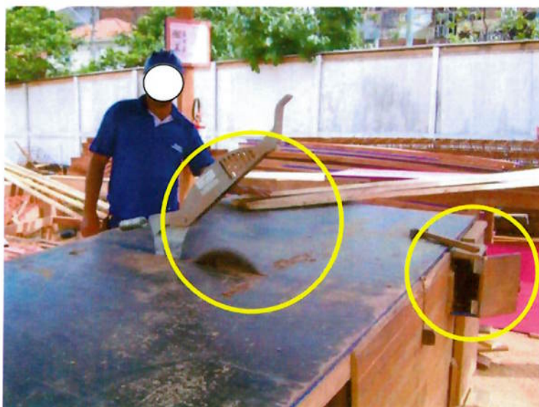
Figura 22 – Detalhe da coifa erguida em operação.
