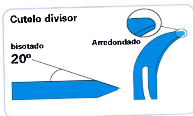
Figura 06 – Detalhe da construção do cutelo divisor
